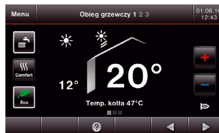
Nowy elektroniczny regulator Vitotronic 200 z kolorowym wyświetlaczem dotykowym
